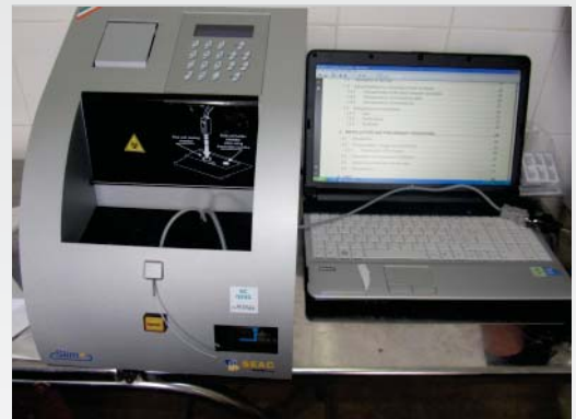
El Fotómetro es un instrumento de laboratorio clínico, que permite la determinación de hemoglobina y otros parámetros de química sanguínea. Su adquisición dentro del programa conjunto esta enfocada a apoyar la determinación de hemoglobina en la atención primaria de salud y con ello fortalecer la vigilancia de la anemia.
